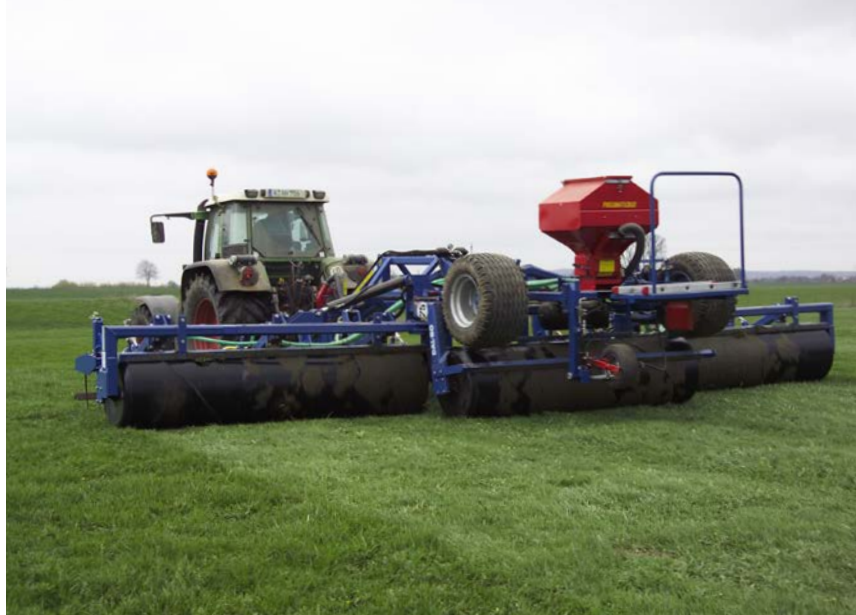
△ Mindestens ein Walzendurchgang nach der Saat ist unerlässlich. Er garantiert den Bodenschluss und schützt den Sämling vor Trockenheit.
